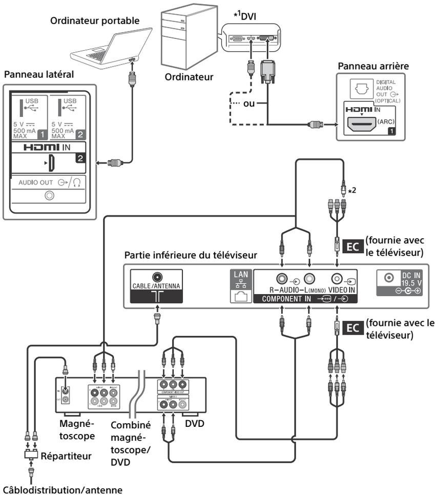
\*1 La prise DVI ne prend pas en charge les signaux audio. Connecter la sortie audio de l'ordinateur aux enceintes d'ordinateur ou à un récepteur audio-vidéo pour écouter le son de l'ordinateur.
