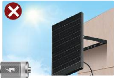
VỊ TRÍ LẮP ĐẶT SAI
