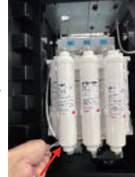
19. Gắn ống nhựa PE ở bước 18 vào đầu vào của bộ lọc Tourmaline.
