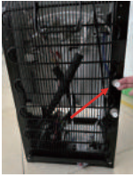
6. Tháo chốt ở ngò cấp nước.
