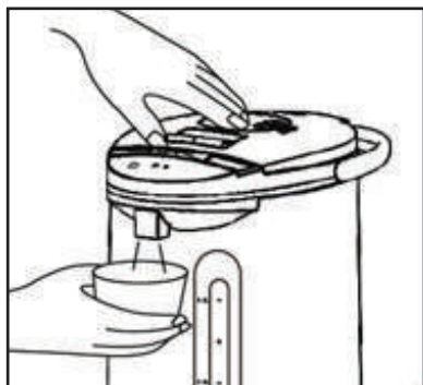
Rót đầy nước bằng bơm tay
