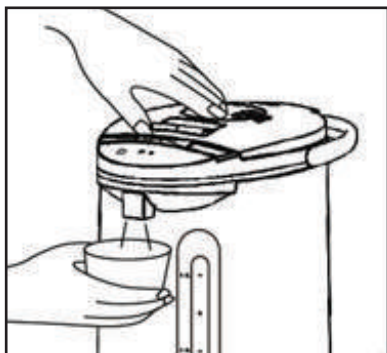
Pour water with air pump
