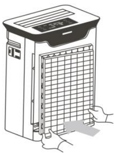
4. Lắp bộ lọc HEPA
