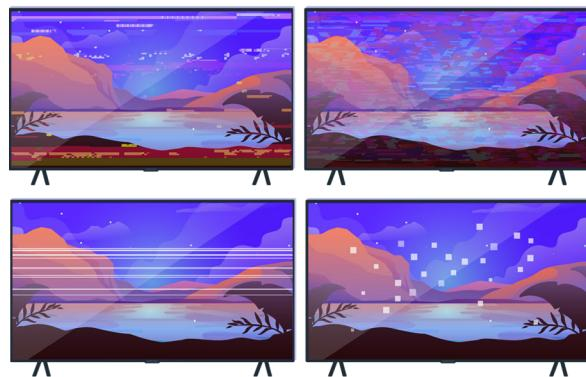
Nếu sự cố vẫn tiếp diễn, hãy xác định chính xác sự cố hiển thị là gì. Ví dụ: các mảnh ghép và khối hình, nhiều dòng, chấm trắng, đường ngang hoặc dọc cố định.
