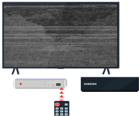
Nếu bạn sử dụng Điều khiển từ xa đa thương hiệu (MBR) hoặc điều khiển từ xa phổ thông và điều khiển từ xa của bạn không thể vận hành thiết bị ngoại vi, hãy di chuyển thiết bị ngoại vi đến gần Hộp One Connect.
