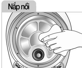
Trường hợp nước cơm đọng lại trên nắp trong nồi, hãy tháo rời nắp trong rồi lau sạch bằng khăn khô. Phần ri-a bên trong của nắp nồi được làm bằng kim loại nên cần chú ý kỹ khi vệ sinh. (Lưu khi không làm biến dạng nắp nồi, sau khi vệ sinh cần lắp lại vùng nồi rồi mới sử dụng)
