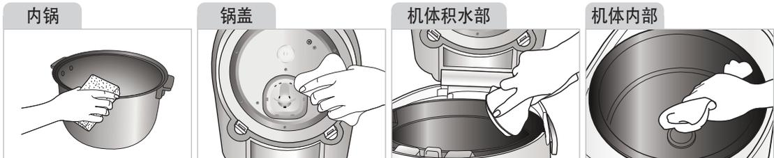
擦净内锅外部及底部的异物及水渍，清洗时请用柔软的抹布或海绵清洗，严禁使用钢丝球、铁刷、研磨剂以免涂层脱落。
