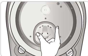
1. Nắp thoát hơi nước nên được làm sạch sau mỗi lần sử dụng. Tháo nắp hơi bằng cách kéo nó ra khỏi nắp.
