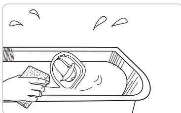
2. 如图所示将蒸汽帽分离后浸泡在温水中，用柔软的抹布或海绵清洗后，擦除水渍。
