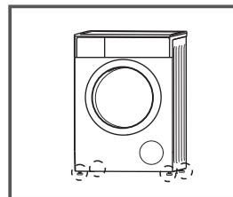
2. Kiểm xem chân máy nào chưa chạm vào mặt nền đặt máy. Nếu chân nào chưa chạm, hãy dùng khóa vặn để mở đai ốc theo chiều kim đồng hồ và hạ chân máy xuống.
