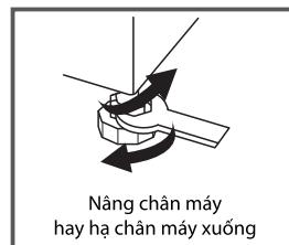
3. Sau khi đã điều chỉnh chân máy, phải dùng khóa vặn đai ốc trên 4 chân máy - theo chiều ngược chiều kim đồng hồ, để siết chặt đai ốc sát vào mặt đáy của máy giặt.
