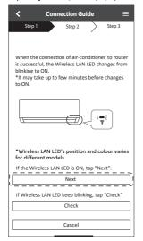
② Kiểm tra đảm bảo đèn LED Wireless LAN (LAN Không dây) đã ON (BẬT). Nhấn nút Wireless LAN (LAN Không dây) ♀ trong vòng 5 giây cho đến khi số "1" xuất hiện trên điều khiển từ xa. Hướng điều khiển từ xa tới máy điều hòa và nhấn nút
