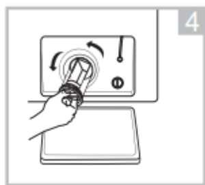
Mở bộ lọc bằng cách quay ngược chiều kim đồng hồ
