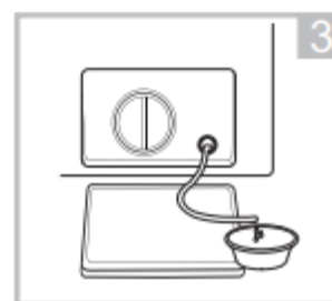
Sau khi hết nước, đặt lại ống thoát nước
