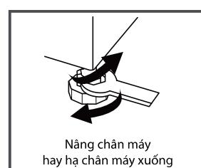
3. Sau khi đã điều chỉnh chân máy, phải dùng khóa vặn đai ốc trên 4 chân máy - theo chiều ngược chiều kim đồng hồ, để siết chặt đai ốc sát vào mặt đáy của máy giặt.
