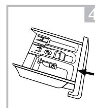
Nhấn vào vị trí có mũi tên để lấy hộp ra khỏi máy, rồi nhắc nắp che ngăn nước xả vải lên để lấy nắp ra khỏi hộp.
