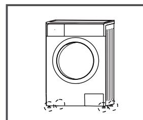
2. Kiểm xem chân máy nào chưa chạm vào mặt nền đặt máy. Nếu chân nào chưa chạm, hãy dùng khóa vặn để mở đai ốc theo chiều kim đồng hồ và hạ chân máy xuống.
