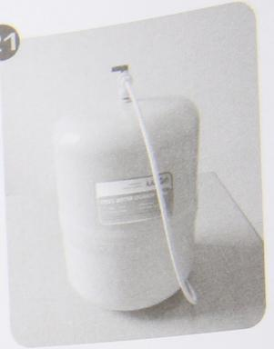
Khi bình áp đầy máy lọc nước sẽ tạm ngừng hoạt động. Tiến hành ngắt nguồn điện và khóa van bình áp. Đưa bình áp ra bên ngoài máy, tháo cút ốc nối dây RO của bình và mở van bình áp để xả toàn bộ nước bên trong, nhằm làm sạch các chất bảo quản của bình áp mới. Quá trình này được lặp lại 2 đến 3 lần.
