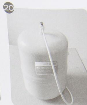
Cung cấp lại nguồn điện cho máy nhâm tiến hành xả rửa toàn bộ hệ thống máy qua vòi cổ ngỗng để loại bỏ các chất bảo quản của vòi. Thực hiện xả trong vòng 5 - 10 phút. Sau đó đóng vòi cổ ngỗng lại và mở van bình áp cho nước tinh khiết chảy vào bình chứa.
