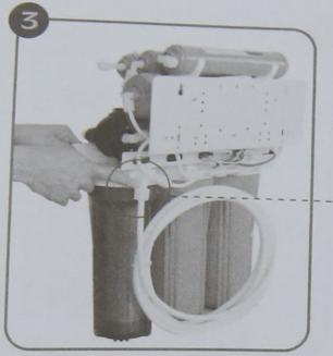
Nối dây RO to với cút đầu vào của cốc lọc số 1. Khi lắp đặt cần đảm bảo cút ốc phải được quấn băng tan và xiết hết ren nhằm tối ưu lực liên kết giữa dây RO và cút ốc.
