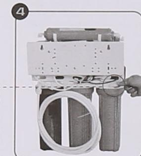
Tại cút đầu ra của cốc lọc số 3, tháo dây RO nối từ vị trí này với đầu vào của màng RO. Sau đó lấy đoạn dây RO nhỏ (rời bên ngoài) nối trực tiếp từ cút đầu ra của cốc số 3 đến vị trí xả nước để chuẩn bị quá trình sục rửa các lõi 1,2,3.
