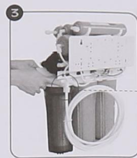
Nối dây RO to với cút đầu vào của cốc lọc số 1. Khi lắp đặt cần đảm bảo cút ốc phải được quấn băng tan và xiết hết ren nhằm tối ưu lực liên kết giữa dây RO và cút ốc.
