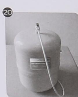
Cung cấp lại nguồn điện cho máy nhằm tiến hành xả rửa toàn bộ hệ thống máy qua vòi cỗ ngỗng để loại bỏ các chất bảo quản của vòi. Thực hiện xả trong vòng 5 - 10 phút. Sau đó đóng vòi cỗ ngỗng lại và mở van bình áp cho nước tinh khiết chảy vào bình chứa.
